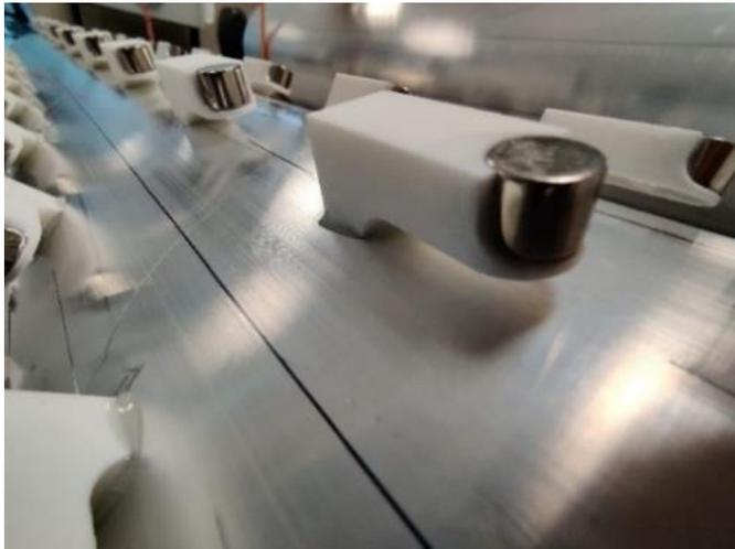
Labordemonstrator eines vibro-akustischen Metamaterials mit periodisch angeordneten Resonatoren auf einer leichten Trägerstruktur. Foto: Fraunhofer LBF
