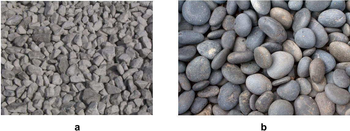
Abb. 3.13. Körner von (a) Schotter und (b) Kies.
