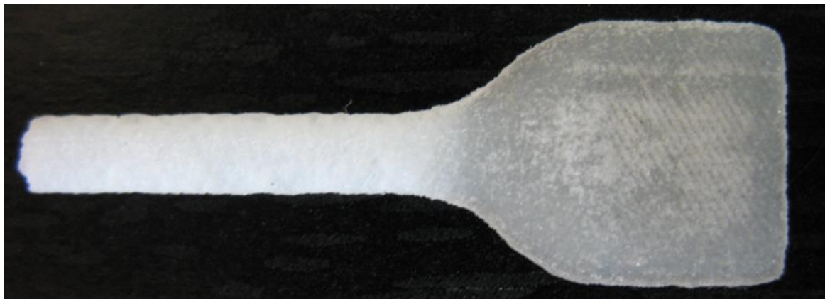
Abb. 9.22. Prüfkörper aus MB2_2-Pulver (F=84 %) nach der Prüfung. Opaker, weißer Steg.
