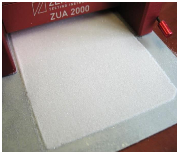
Abb. 9.9. 150 µm dünne Schicht des MB2_2-Pulvers.
