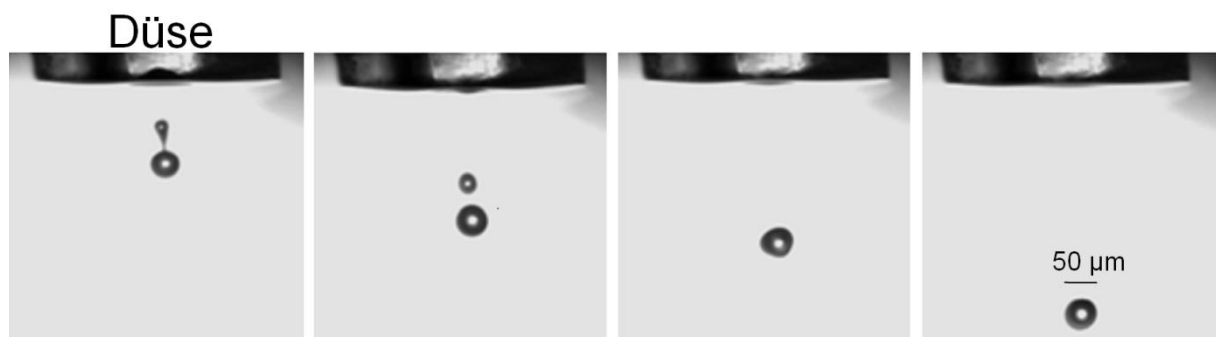
Abb. 3.10. Kontrollierter Ausstoß eines runden BzMA-Tropfens.
