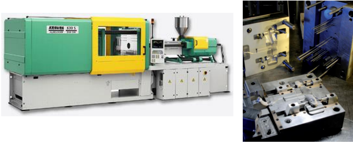
Abb. 1.2. (a) Spritzgussanlage Arburg Allrounder 630 S [10] , (b) mehrteiliges Werkzeug [8] .
