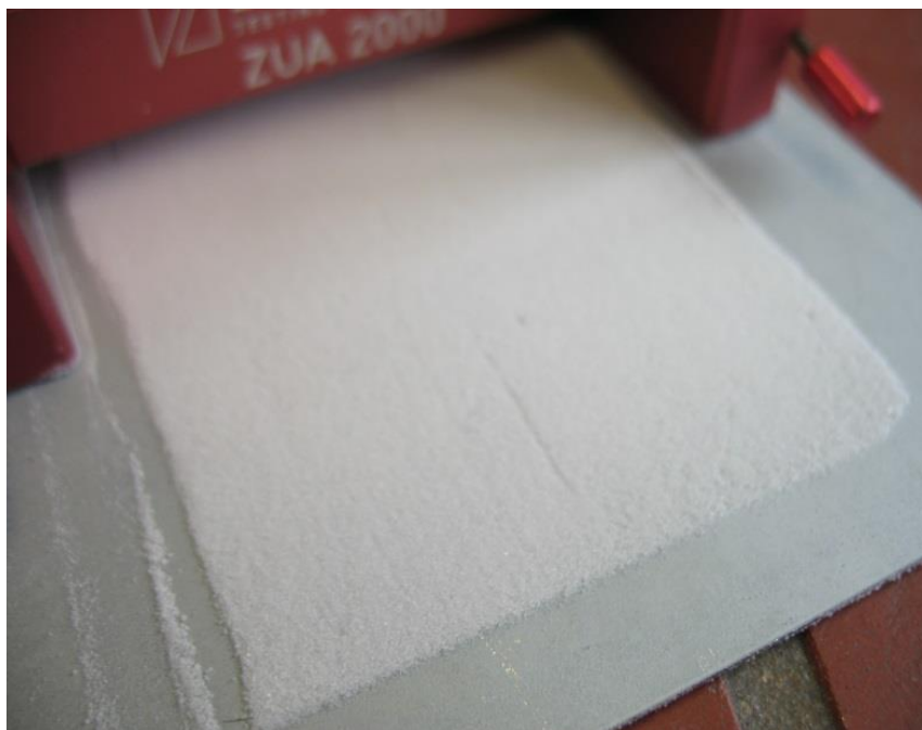
Abb. 6.8. 150 μm dünne Schicht aus MB1-Pulver.
