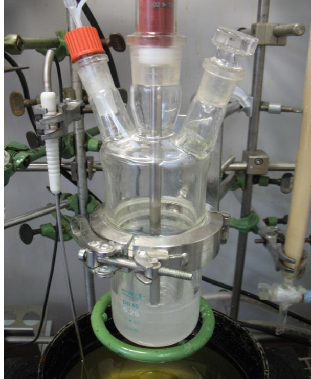
Abb. 5.9. 250 mL-Reaktor mit KPG-Rührer und Ölbad. Der Latex wird über die rechte Schlifföffnung zugeführt. Methanol wird über eine Pumpe durch die linke Schlifföffnung dosiert.
