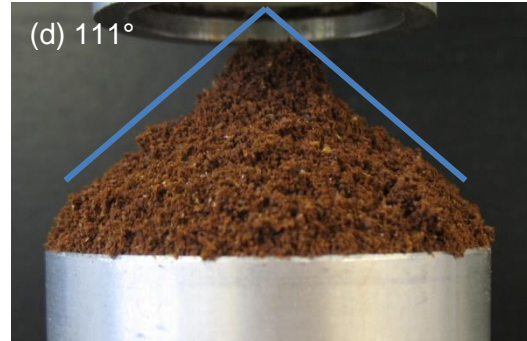
Abb. 3.15. Schüttwinkel des (a) Polypor-Pulvers und von (b) Zucker, (c) Mehl und (d) Kaffee.
