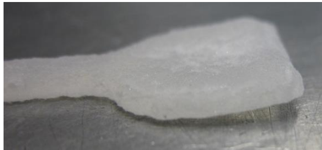
Abb. 11.2. Verzogener und inhomogen gefüllter Druckkörper aus MB1-Pulver.
