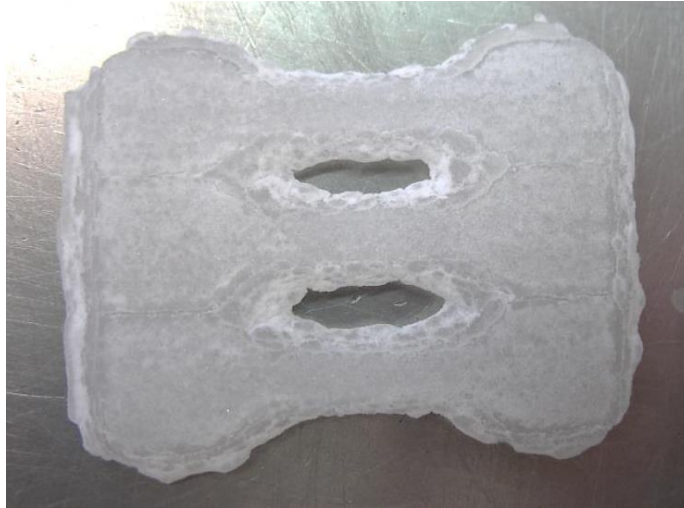
Abb.3.2. Stark verlaufenes Druckergebnis bei hohem Füllgrad.
