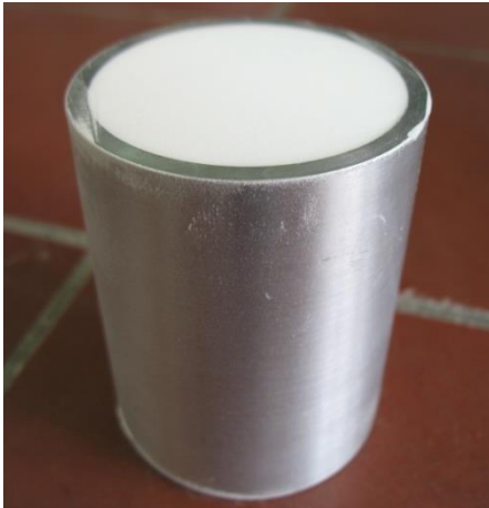
Abb. 3.17. Schüttdichtenbestimmung: Plan gefüllter Normbecher.
