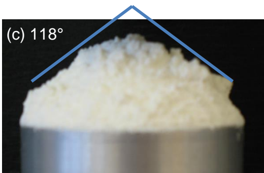
Abb. 3.15. Schüttwinkel des (a) Polypor-Pulvers und von (b) Zucker, (c) Mehl und (d) Kaffee.
