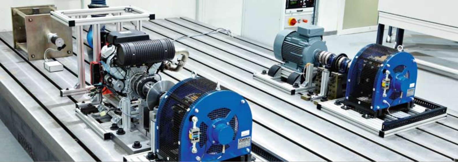
Prüfstand zur Umsetzung aktiver Systeme im Antriebsstrang. Test rig for the implementation of smart systems in a drive train.
