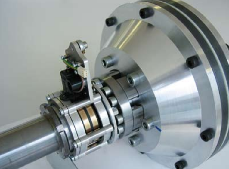
Im Hinblick auf Zuverlässigkeit und Funktionssicherheit zu untersuchende aktive magnetorheologische Kupplung des Fraunhofer LBF. Active magnetorheological clutch of Fraunhofer LBF being examined for its reliability and functional safety.
