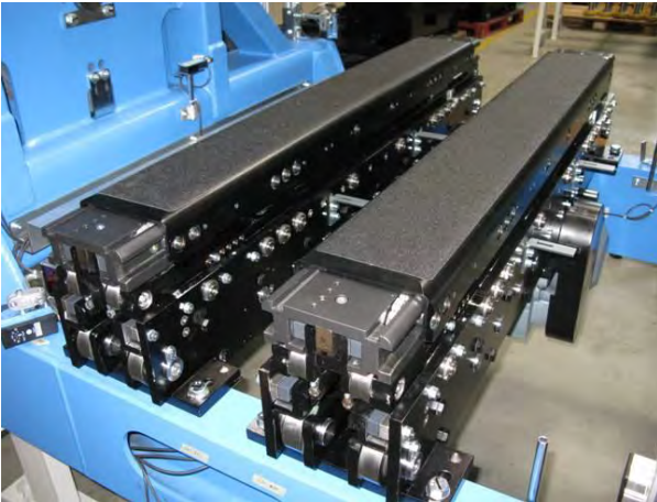
Abbildung 4: Doppeltiefe Teleskopgabel für Paletten (Quelle: Dambach Lagersysteme GmbH & Co. KG)
