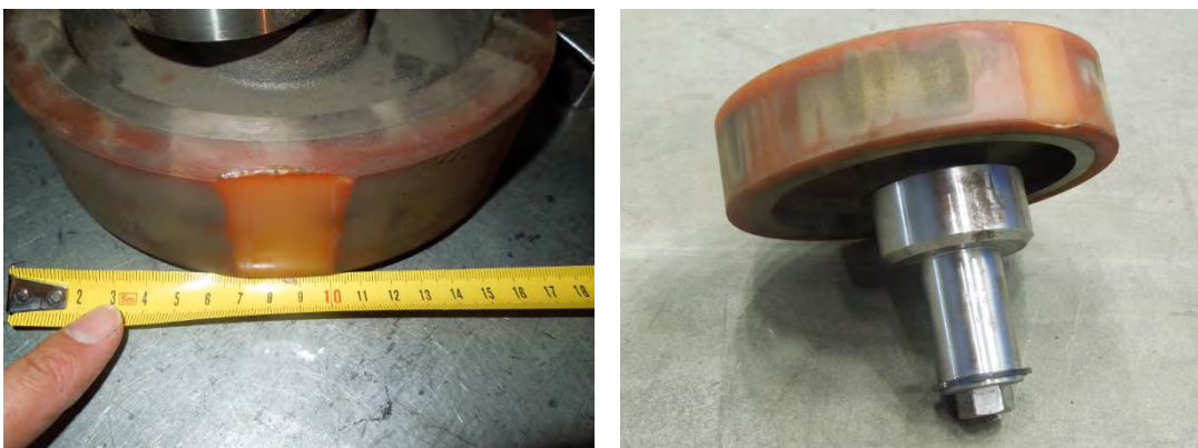
Abbildung 15: Abgeplattete Führungsrolle (links: vor dem Einsatz, recht: danach)
