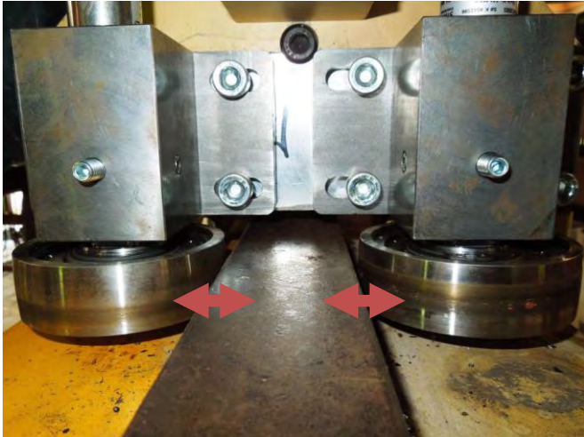
Abbildung 24: Variation des Führungsspiels der Führungsrollen auf der rechten Seite des Krans.
