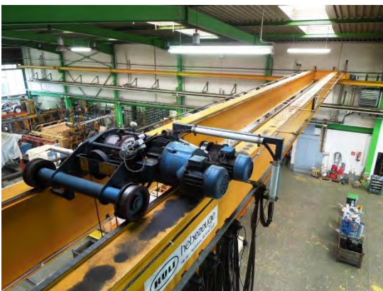
Abbildung 5: links - Zweiträger-Kastenträger-Brückenkran, rechts - Antriebseinheit eines Kranfahrwerks mit Spurführungsrollen (Quelle: KULI Hebezeuge – Helmut Kempkes GmbH)
