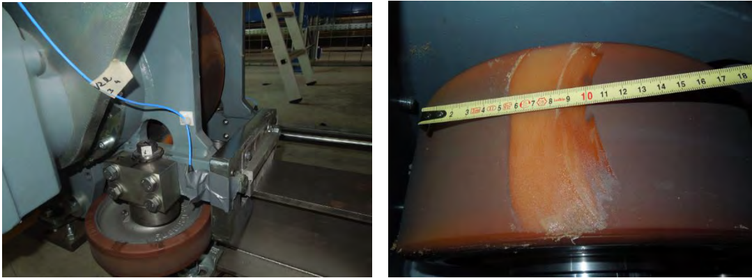
Abbildung 14: Durch Bearbeitung mit einer Schleifscheibe abgeplattetes Antriebsrad
