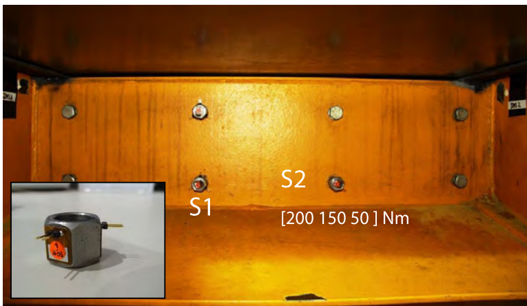
Abbildung 29: Positionen und Bezeichnungen der untersuchten Schrauben am Laufkran
