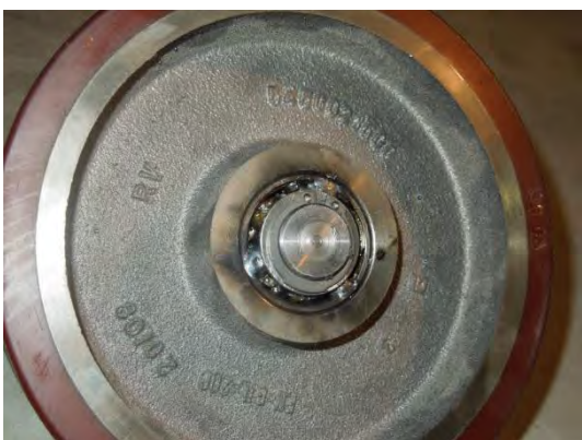
Abbildung 16: Durch Schweißpunkte blockierte Führungsrolle
