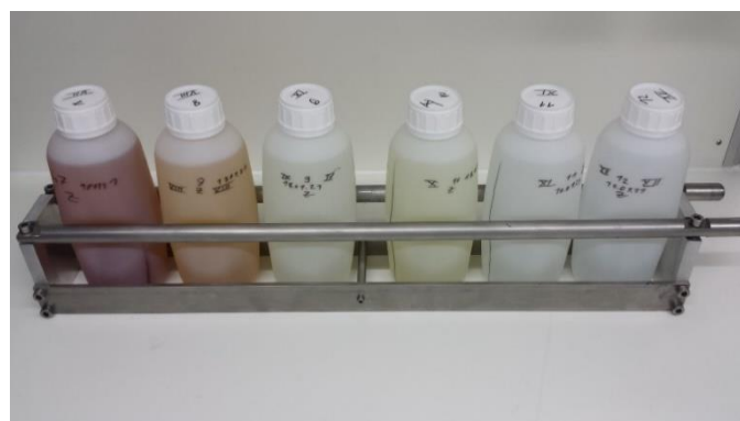
Abb. 2: Quetscheinrichtung mit Testflaschen aus PE-HD
