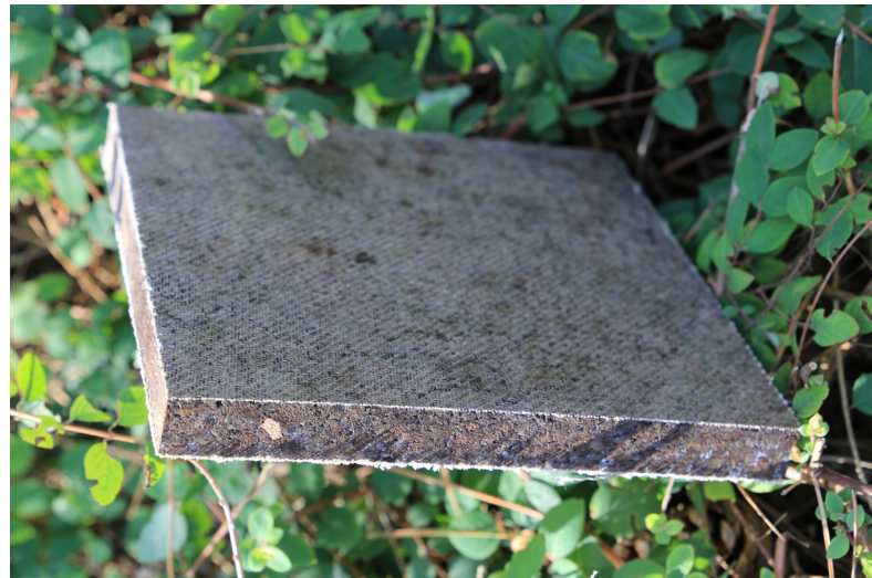
Sandwich-Leichtbauplatte aus nachwachsenden Rohstoffen: Flachfasergewebe als Deckschicht und Korkgranulat als Kern-Material.
