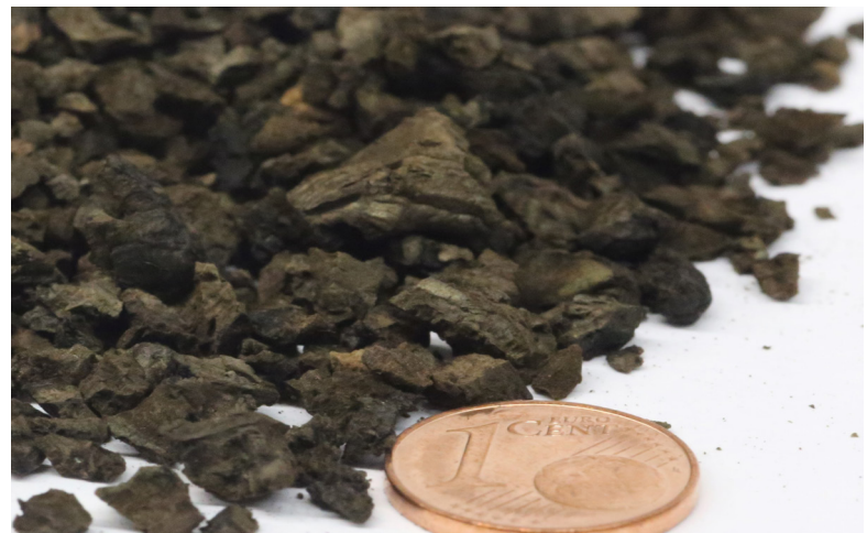
Korkgranulat als Rohstoff für Sandwich Kernmaterialien.
