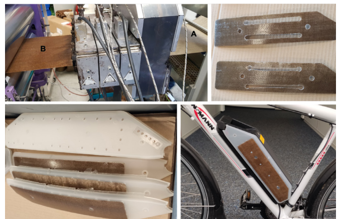
Aus Flachsgewebe (A) und Polypropylen werden dünne Organobleche (B) gefertigt, die zur Verstärkung der Gehäuseblenden eines E-Bike-Akku dienen. © Ansmann AG & Fraunhofer LBF.
