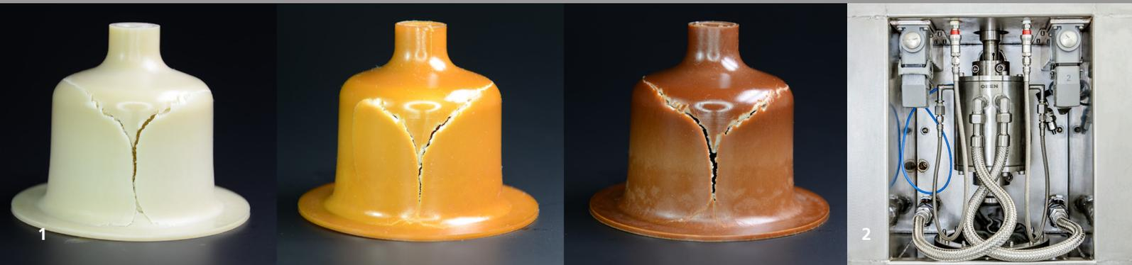
1 Geprüfte und unterschiedlich eingelagerte Prüfkörper
