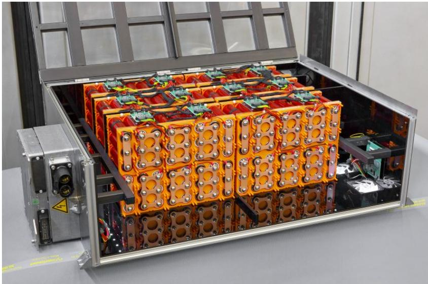
Forscher des Fraunhofer LBF haben ein leistungsstarkes 10 kWh Batteriesystem mit eigensicheren LFP-Zellen sowie integriertem Batterie-Managementsystem für das institutseigene Konzeptfahrzeug entwickelt und aufgebaut.
