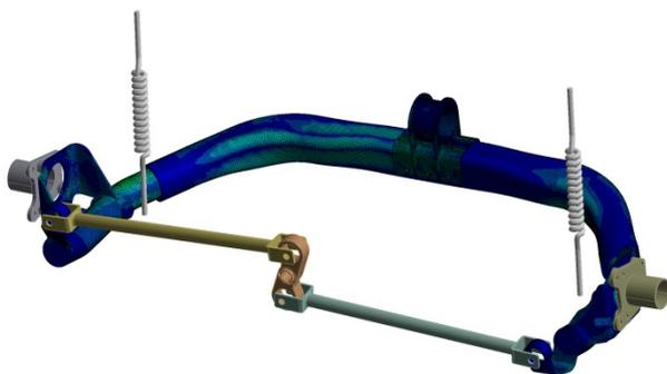
Simulationsmodell der im Fraunhofer LBF entwickelten Leichtbauachse.
