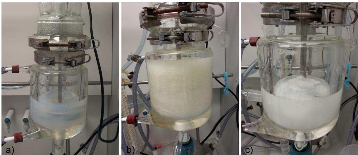
Abbildung 4.1.9 Dispergierverhalten von PUD unter Verwendung unterschiedlicher Diisocyanate. a) mit IPDI (dispergiert); b) mit MDI (gelbstichig/ausgefallen); c) mit HDI (ausgefallen).
