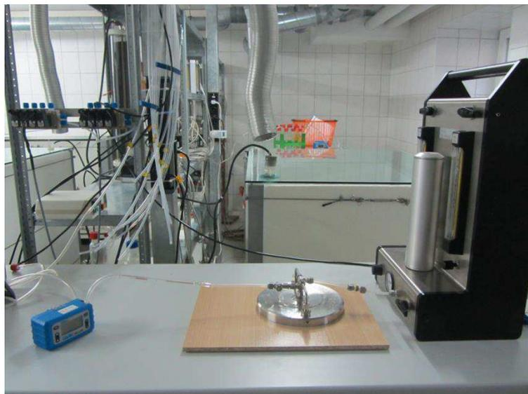
Abbildung 4.3.7 Erfassung von VOC-Emissionen mittels Flec-Meßzelle.
