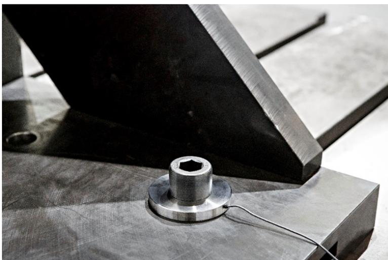
Die kraftmessende Unterlegscheibe auf Basis der Delta-C®-Technologie aus dem Fraunhofer LBF kann für die Überwachung von Windenergieanlagen verwendet werden. Foto: Fraunhofer LBF, Raapke
