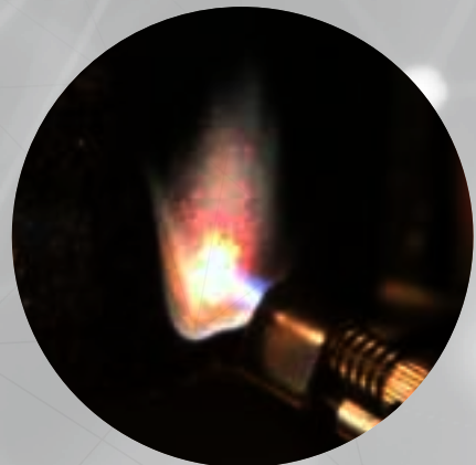
Behandlung eines OrganoPor-Materials mit einem Gebläsebrenner.
