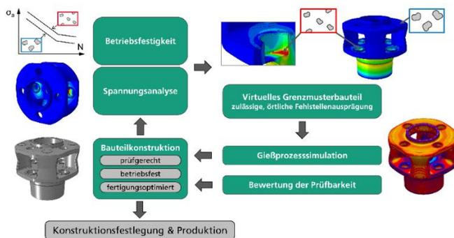
Disziplinübergreifender Austausch für optimierte Gussbauteile: Der Kongress »InCeight Casting C<sup>8</sup>« startet sein Call für Papers. Grafik: Virtuelles Grenzmusterkonzept, Fraunhofer LBF.
