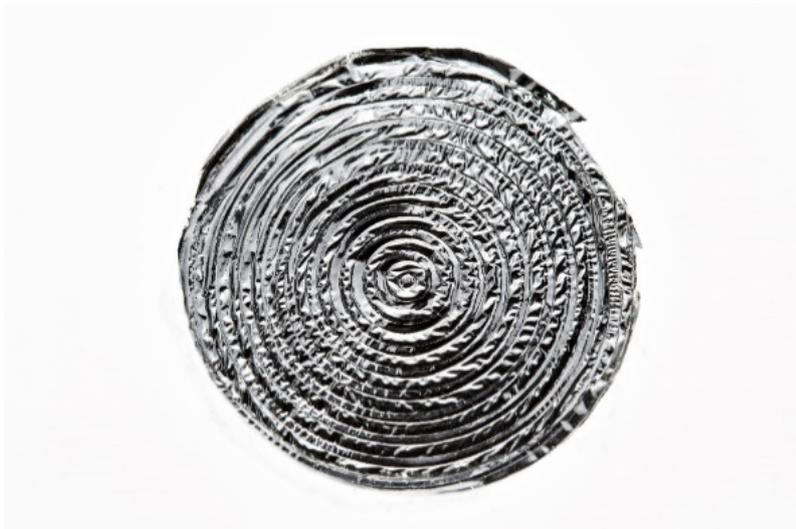
Piezoelektrite sind hochflexible, flächige Wandler und können in elastische Strukturen (z. B. Kleidung) als Sensoren oder zur Energieumwandlung integriert werden.
