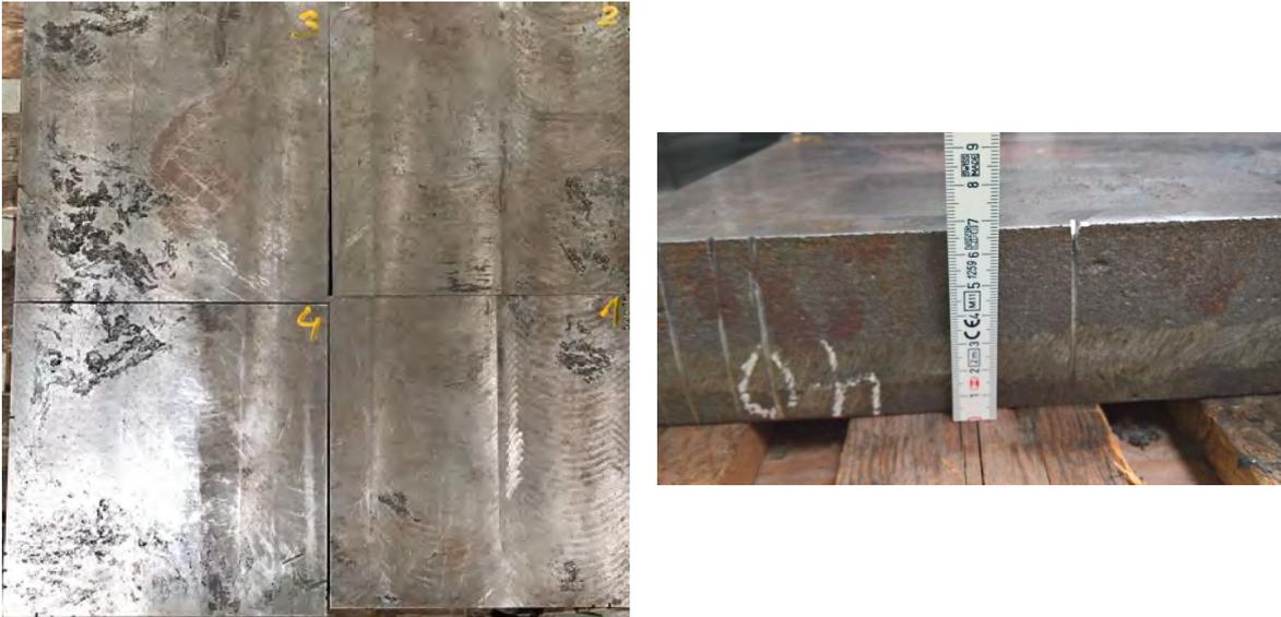
**Bild 25 Links: Foto der überfrästen Oberfläche des geviertelten Versuchskörpers MAN 5261600 (Teilsegment Nr. 1-4); Rechts: Reduzierte Versuchskörperhöhe (zuvor ca. 200 mm nach Bearbeitung ca. 68 mm)**
