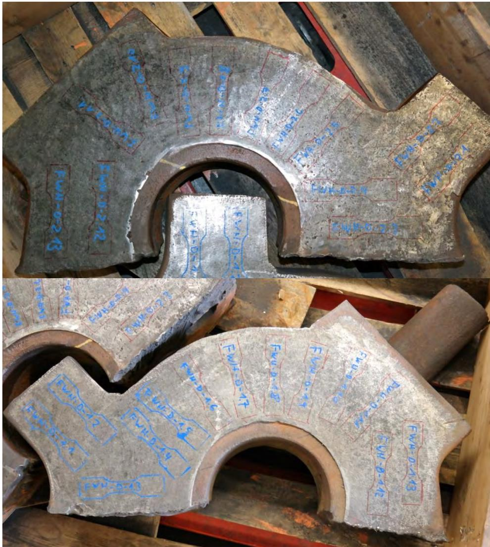
Bild 39 Bauteilabschnitt von Partner FWH mit eingezeichneter Probenlage
