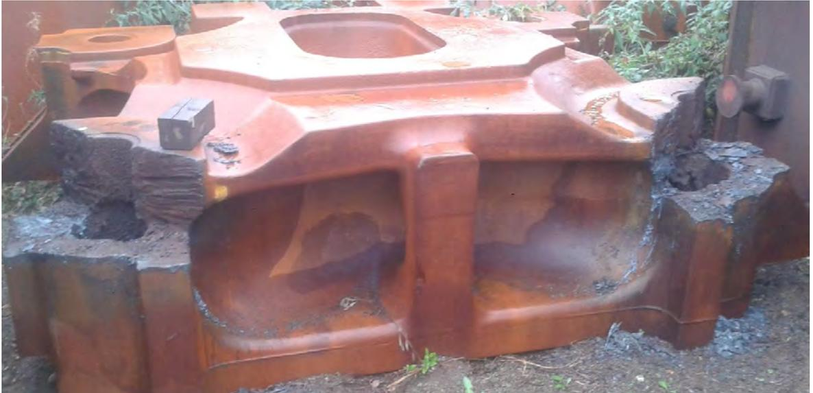
**Bild 18 Bauteil für Kunststoffspritzgießmaschine aus EN-GJS-400-18 mit einer Gießmasse von ca. 22 t mit herausgetrennten Bauteilbereichen**
