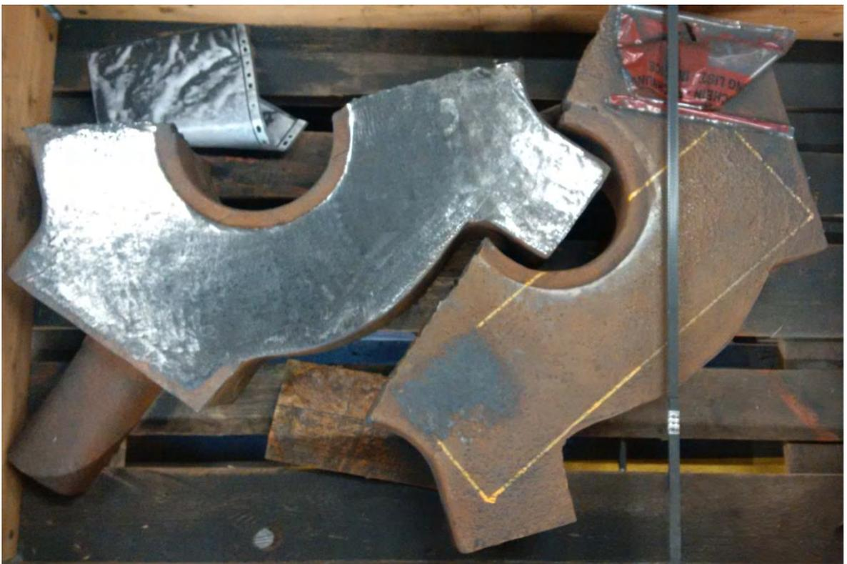
**Bild 19 Herausgetrennte und mit Dross behaftete Bauteilabschnitte**
