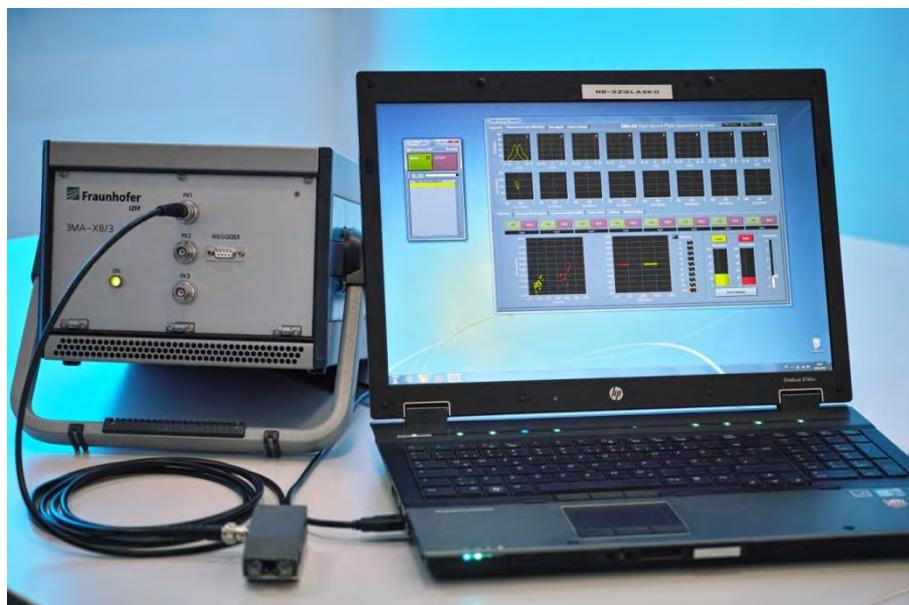
**Bild 15 3MA-X8-Prüfgerät inklusive Sensor (Bauform 1030-X8) und Laptop mit Software zur Ansteuerung und Auswertung**
