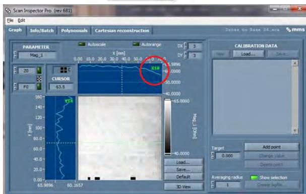
Mechanisierte MikroMach-Messung von der Seitenfläche des Versuchstestkörpers (exemplarische Kenngröße)
