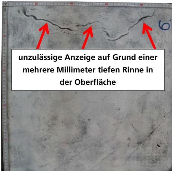
**Bild 32 Unbearbeiteter Versuchskörper nach der Magnetpulverprüfung mit Methode schwarz/weiß und einer unzulässigen Anzeige**
