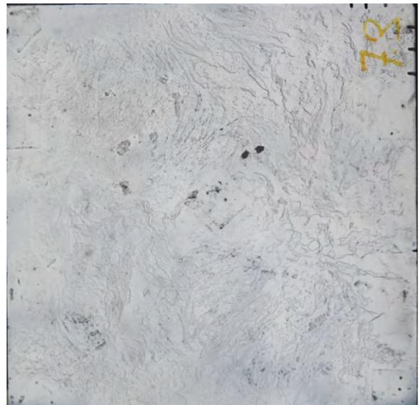
**Bild 33 Versuchskörper nach der Magnetpulverprüfung mit Methode schwarz/weiß mit linien- und kreisförmigen Drossanzeigen**
