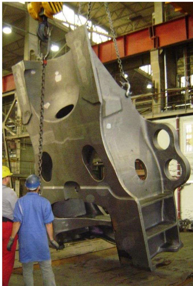
Bild 16 Maschinenträger aus EN-GJS-400-18U-LT mit einer Gieß-
