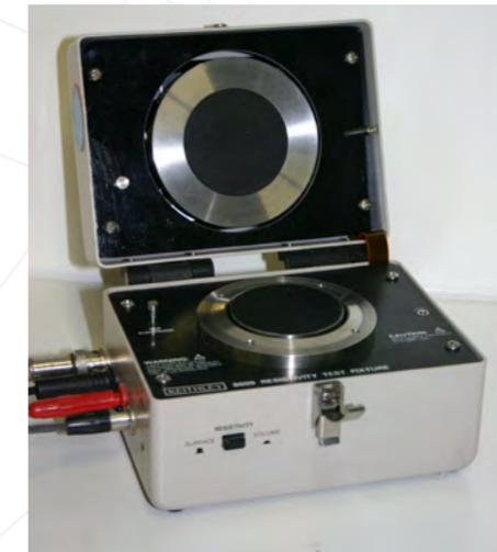
*Messzelle zur Messung der Volumeneitfähigkeit und der Oberflächenleitfähigkeit von Kunststofffolien und Kunststoffplatten.*
