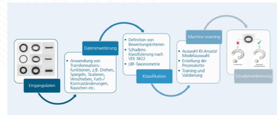
Schematische Darstellung der zur Schadensbeurteilung konzipierten Prozesskette unter Verwendung von elastomerspezifischen Bewertungskriterien und Machine-Learning-Ansätzen.
