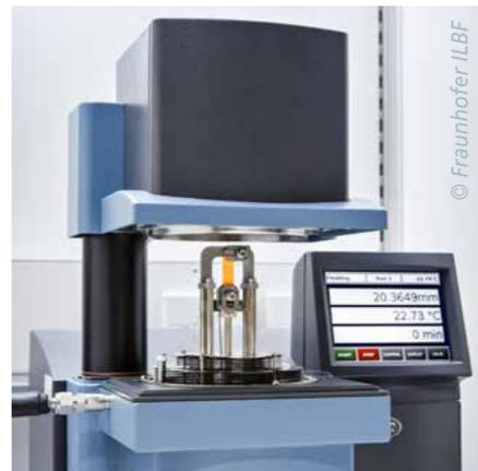
*Materialieigenschaften können mit Hilfe von dynamisch-mechanischen Messungen bestimmt werden. Diese und Ergebnisse aus weiteren Analysen verwenden die Forschenden als Grundlage für Modell-Erstellungen und Simulationen.*
