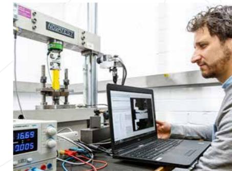
*Experimentelle Schwingfestigkeitsanalyse zur lokalen Schwingfestigkeitsbewertung von Stahl-Aluminium-Schweißnähten mithilfe digitaler Bildkorrelation.*
