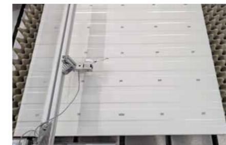
Impulshammermessung des Fraunhofer LBF.
