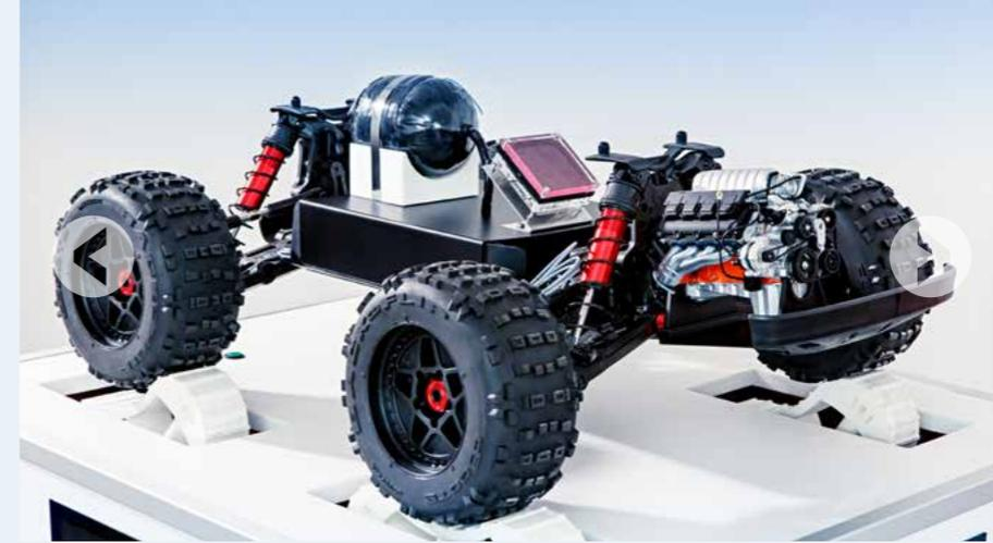
Zuverlässigkeitsbestimmung von Wasserstoffsystemen: Das Fahrzeug mit Tank, Brennstoffzellen, Wasserstoffverbrenner und integrierter Sensorik demonstriert die diversen Belastungen und Ansprüche an die Zuverlässigkeit von Wasserstoffsystemen im Einsatz.
