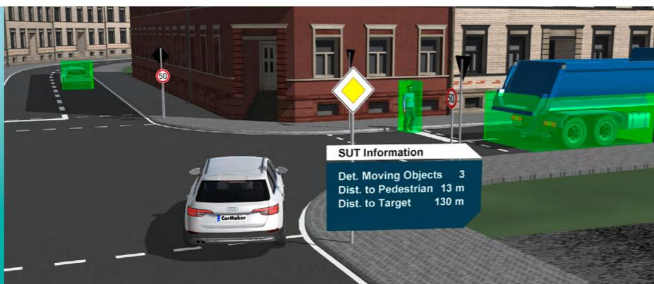
Simulationsbasiertes Testen ermöglicht es, das Verhalten automatisierter Fahrfunktionen mit geringen Kosten und Risiken in vielen Verkehrssituationen zu erproben.
