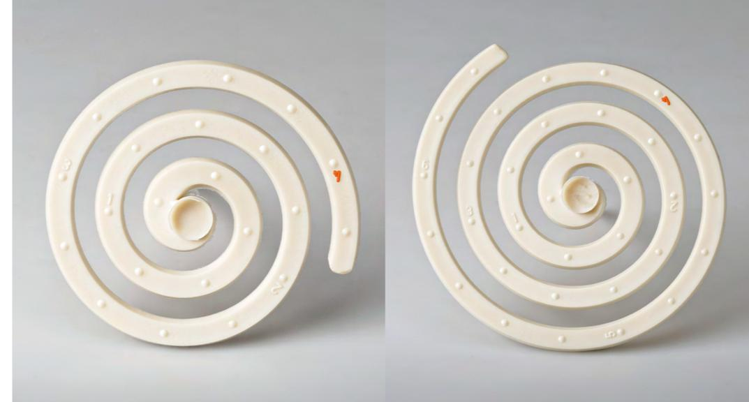
Verbesserte Fließfähigkeit im Spiraltest des Polyamid 6 Blends (rechts) im Vergleich zu kommerziell verfügbarem wärmeleitfähigen Polyamid 6 (links).
