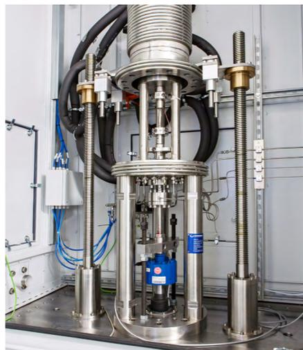
wasserstoff mit Partialdrücken von 7 bar bis 50 bar. Neben der Durchführung von Referenzuntersuchungen in inerter Stickstoffatmosphäre mit einem Druck von 10 bar, besteht auch die Möglichkeit zur Temperierung des Autoklavs, mit regelbaren Temperaturen zwischen -40 Grad Celsius und +130 Grad Celsius.
