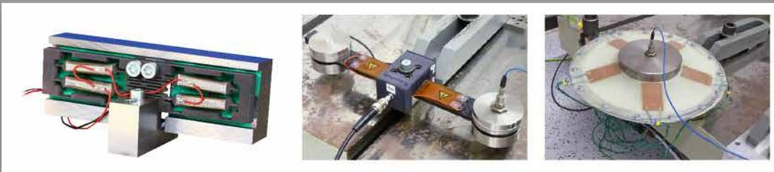
Abb. 2: Verschiedene realisierte Inertialmassenerreger: Starrer Hebelmechanismus mit Multilayeraktor, Biegebalken mit applizierten Piezofolien, Tellerfeder mit integrierten Piezofolien.
