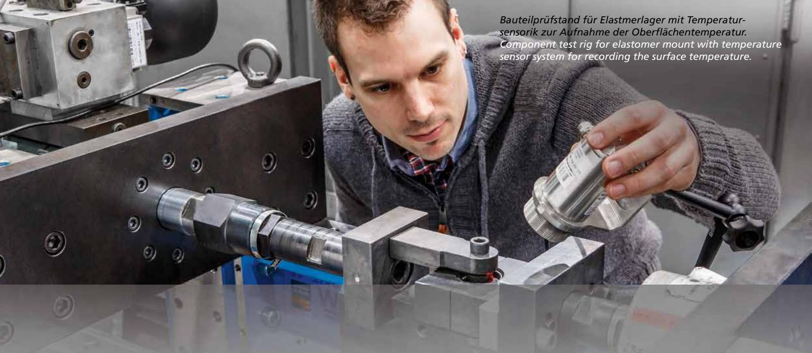
*Bauteilprüfstand für Elastomerlager mit Temperatursensorik zur Aufnahme der Oberflächentemperatur.
