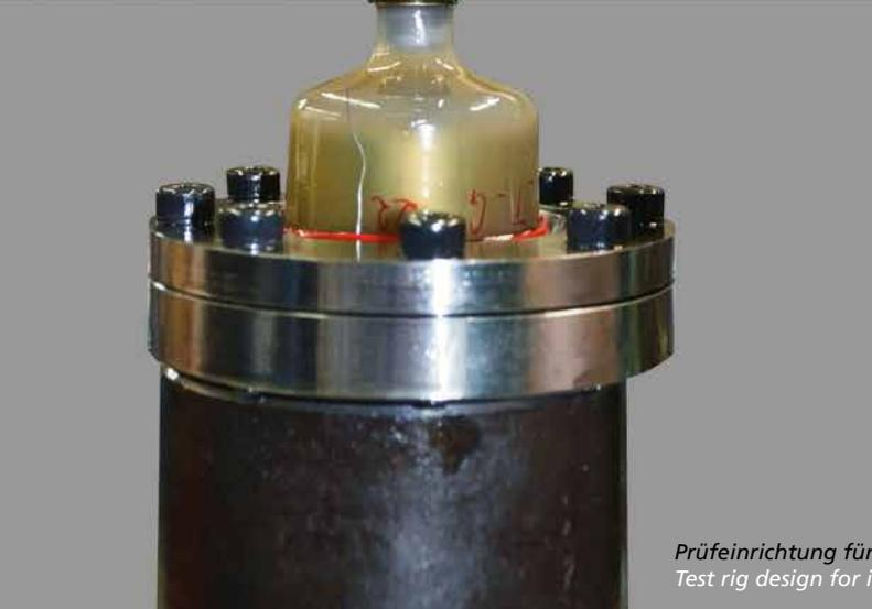
*Prüfeinrichtung für Innendruckversuche.
