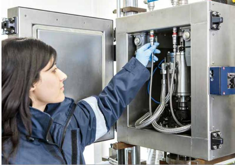
Prüfaufbau zur Ermittlung der Schwingfestigkeit unter dem Einfluss brennbarer Medien.
