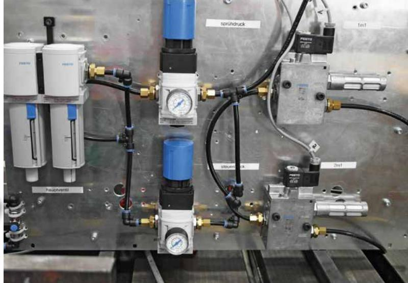
Abb. 2: Apparatur zur Aufbringung der 5% Salzlösung.
