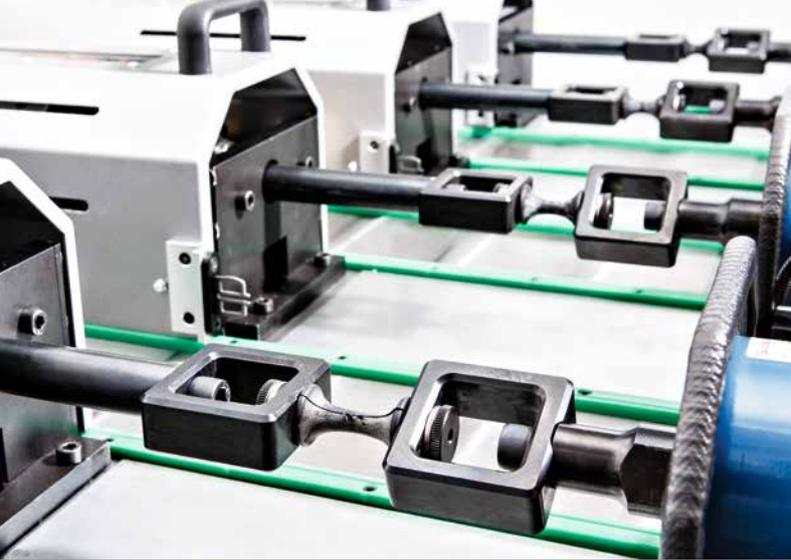
*Prüfung von Materialproben auf unabhängigen Prüfachsen, angetrieben von elektromechanischen Aktuatoren.
