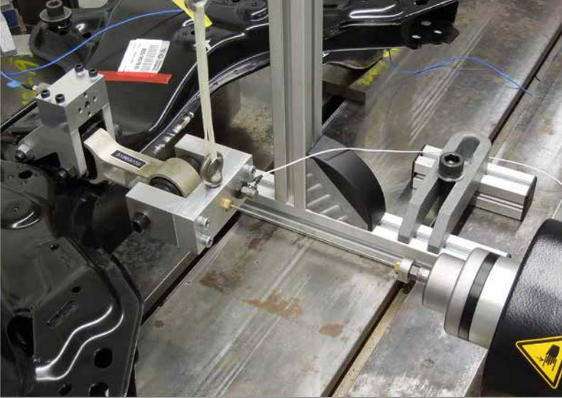
Abb. 1: Versuchsaufbau im Labor mit Hilfsrahmen, Pendelstütze und elektrodynamischem Erreger.
