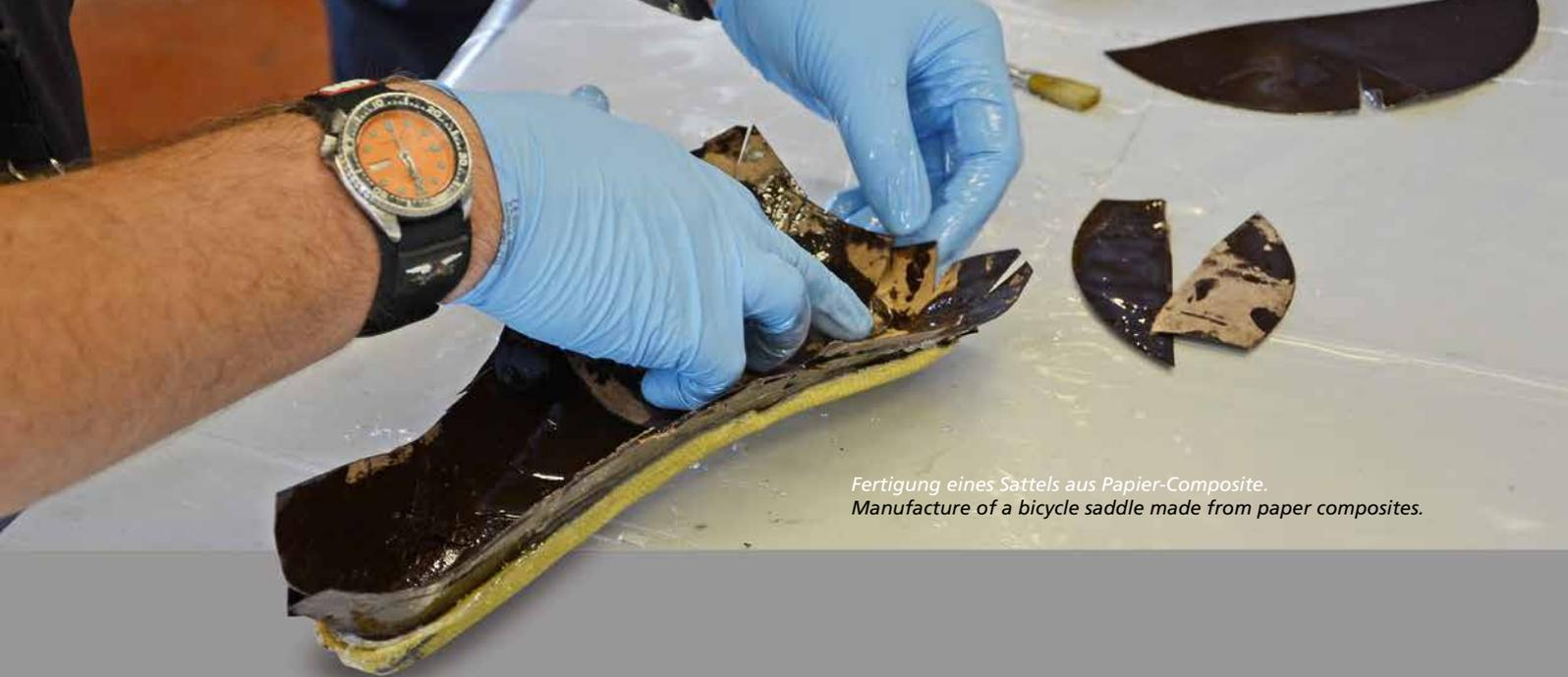
Fertigung eines Sattels aus Papier-Composite.
