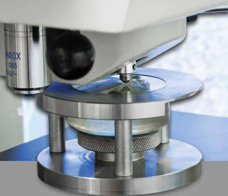
*Härtemessung der Schweißnaht.
