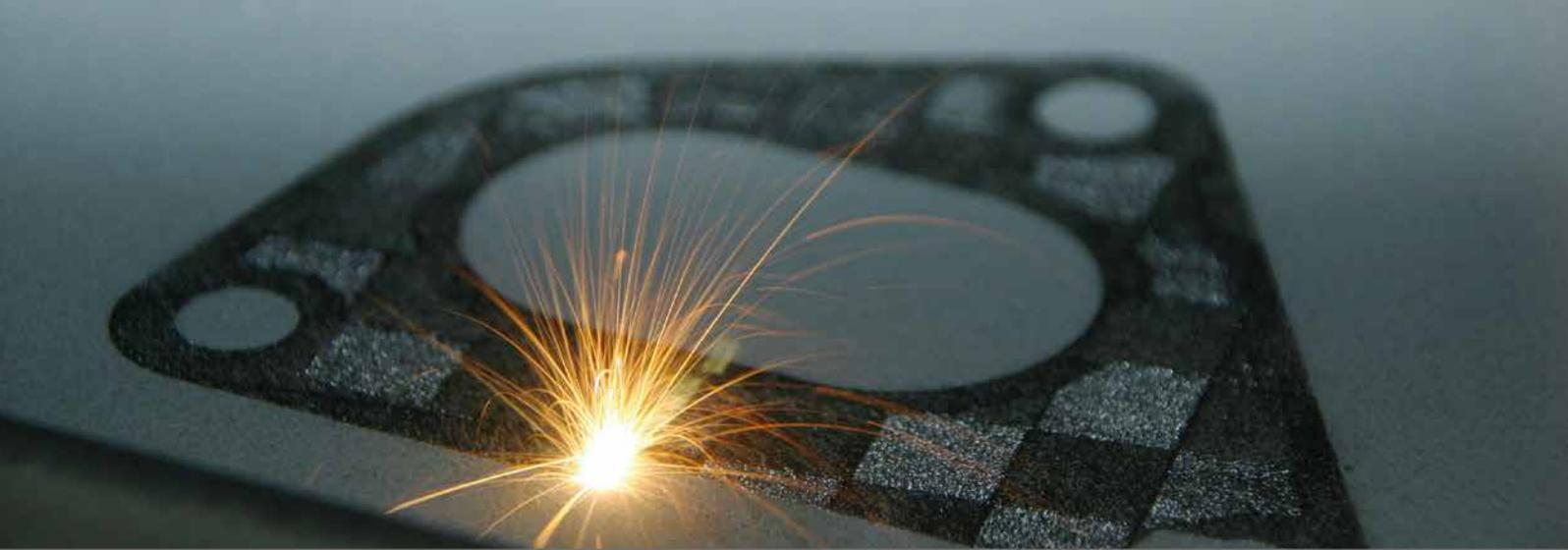
*SLM Belichtung – eine Momentaufnahme im Fertigungsprozess des Moduls.
