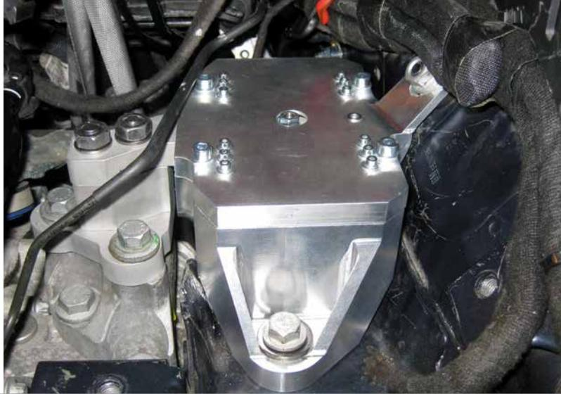
Abb. 2: Komfortsteigerung durch Nachrüsten eines aktiven Motorlagers.
