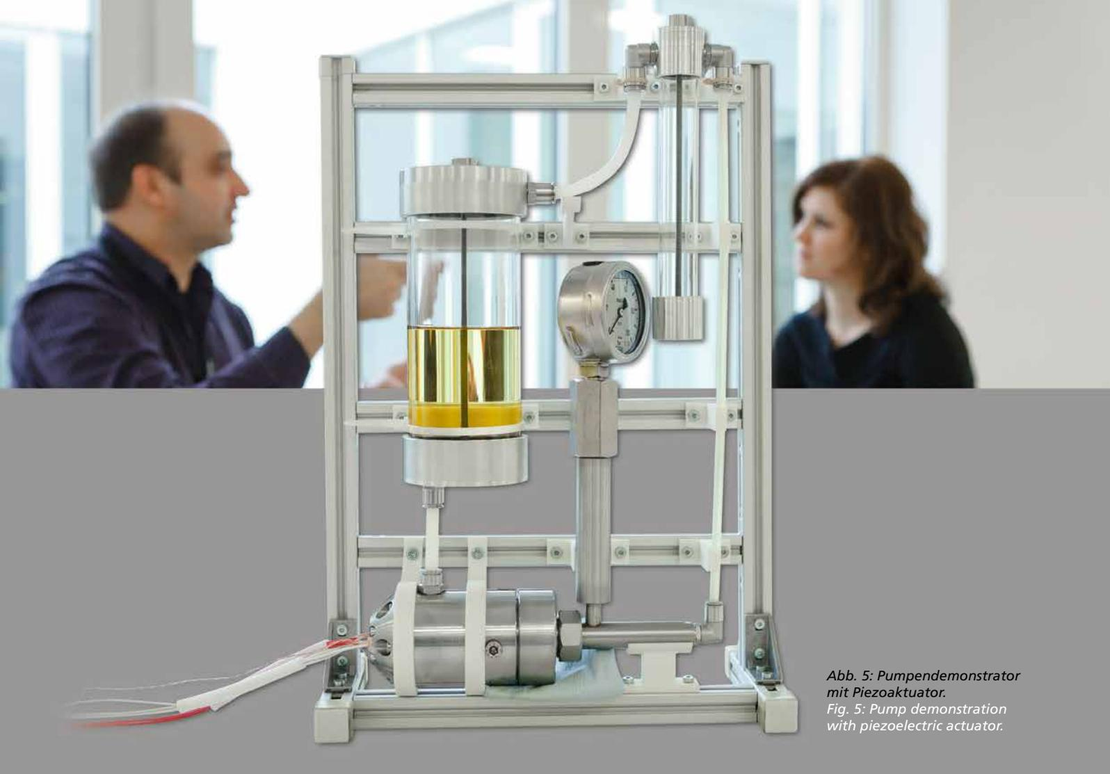
*Abb. 5: Pumpendemonstrator mit Piezoaktuator.
