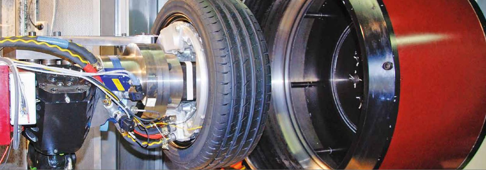
Abb. 1: Elektrischer Radnabenmotor im LBF Straßensimulator WALT.
