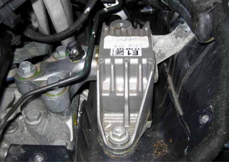
Abb. 1: Herkömmliche Motorlagerung.
