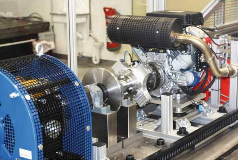
Abb. 1: Semiaktives Fliehkraftpendel im Antriebsstrang.
