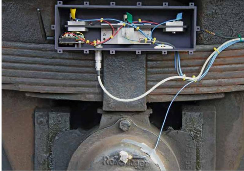
*Intelligenter Sensorknoten zur Stoßdämpferüberwachung.
