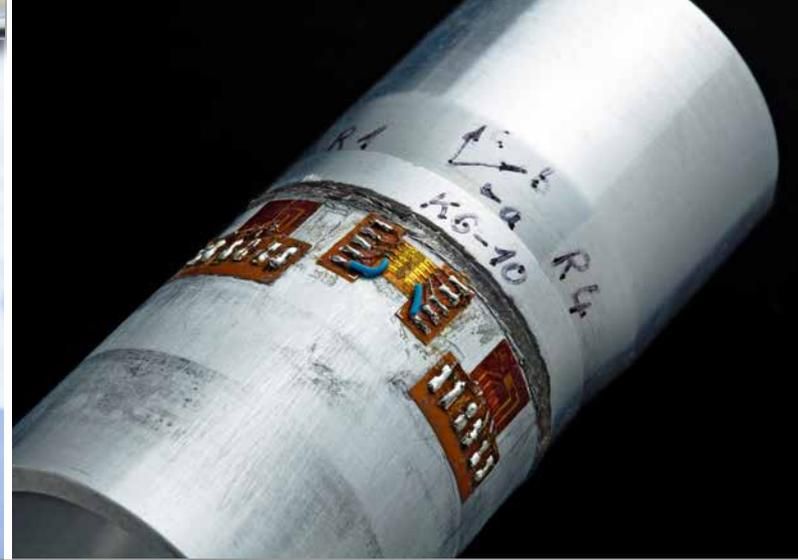
*Laserstrahlgeschweißte Rohrprobe mit applizierten Dehnungsmessstreifen.
