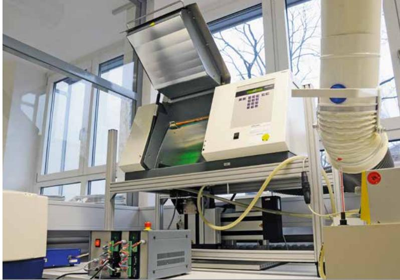
Abb. 1: Ultraschallsensoren zur parallelen Charakterisierung von Beschichtungen in einem Gerät zur simulierten Bewitterung.
