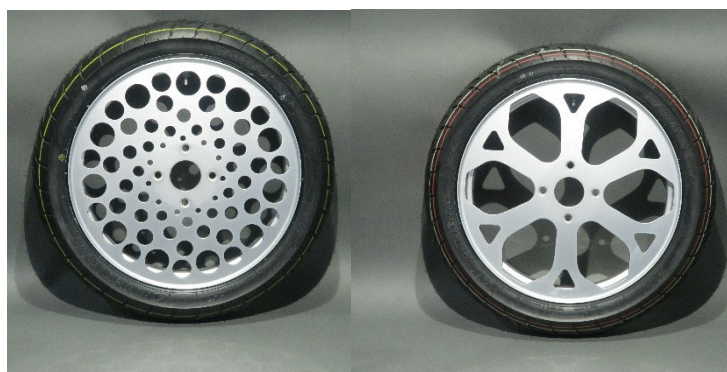
Verschiedene Leichtbauräder für das Lasten-LeichtbauFahrrad.
