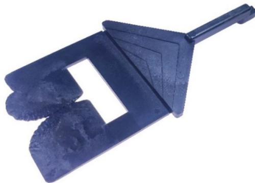
**Herausforderung: hochbeanspruchte Strukturbauteile mit Bindenähten. Das neue Projekt will industrielle Partner aus der Kunststoffbranche befähigen, die Zuverlässigkeit von Bindenähten besser bewerten zu können. Grafik: Fraunhofer LBF**
