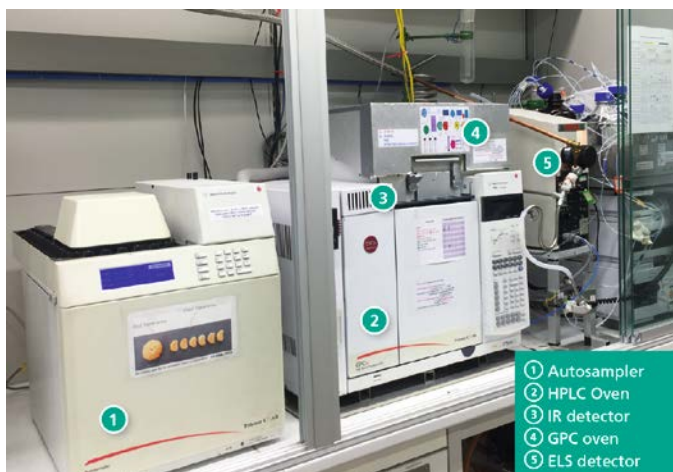
Gerät zur Trennung von Polyolefinen mittels 2-dimensionaler Hochtemperaturflüssigchromatographie. Foto: Fraunhofer LBF
