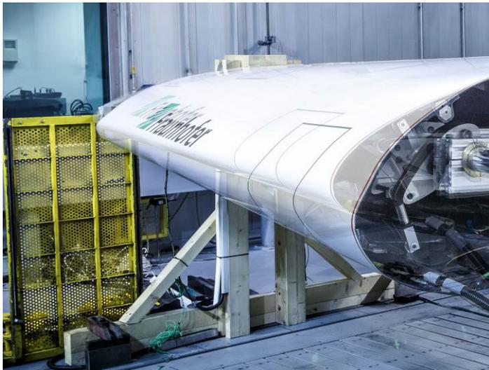
Droop Nose-Demonstrator mit beweglicher Flügelvorderkante und integrierten zukunftsweisenden Technologien.
