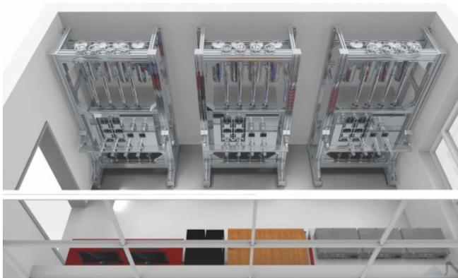
Mit dem völlig neu konzipierten Langzeitprüfstand kann das Fraunhofer LBF das mechanische Langzeitverhalten von Kunststoffen messen, modellieren und simulieren.
