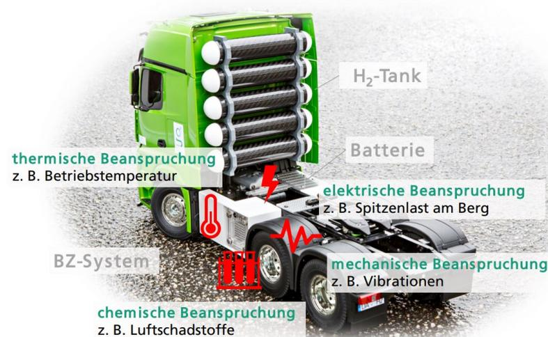
Fraunhofer-Forschende bewerten in »multiPEM« die Systemzuverlässigkeit von Brennstoffzellen-Stapeln unter multiphysikalisch-chemischer Beanspruchung in Nutzfahrzeugen.
