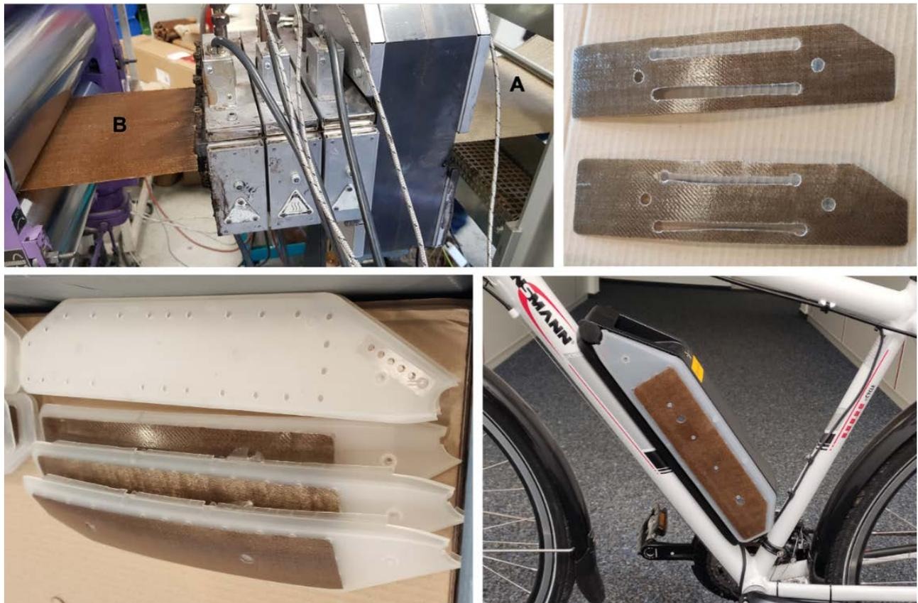
Aus Flachsgewebe (A) und Polypropylen werden dünne Organobleche (B) gefertigt, die zur Verstärkung der Gehäuseblenden eines E-Bike-Akku dienen. © Ansmann AG & Fraunhofer LBF.
