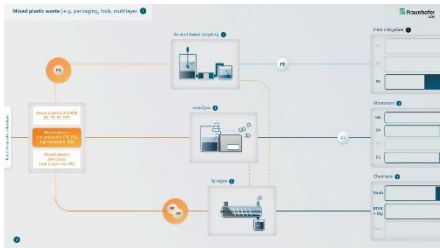
Mit der CCPE-Recyclingkaskade für kunststoffhaltige Abfälle, be- stehend aus einer Kombination von drei Fraunhofer-Technologien, können hochwertige Kunststoff- Rezyklate bei einer optimierten Produktausbeute erzeugt werden. © Fraunhofer CCPE
