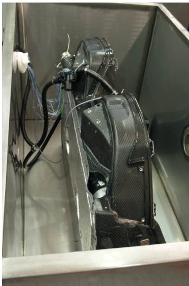
Monocoque des Porsche 918 Spyder mit eingebautem Drucktank. Foto: Fraunhofer LBF
