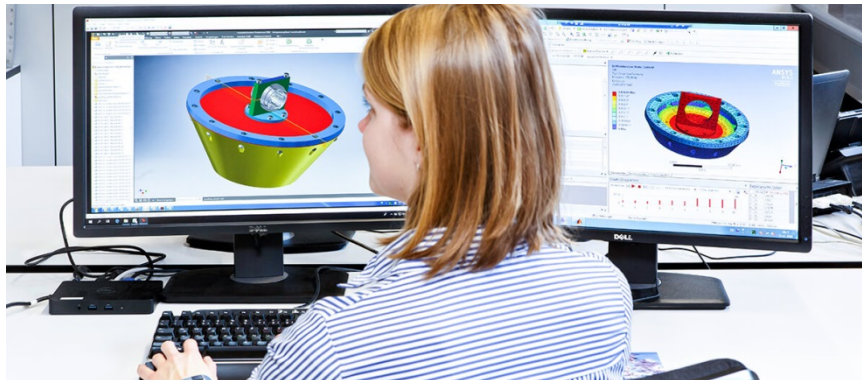
Numerische Simulation des Gesamtaufbaus zur Resonanzbestimmung. Foto: Fraunhofer LBF/Raapke
