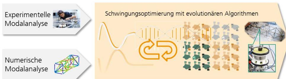
Ablauf einer schwingungstechnischen Optimierung basierend auf evolutionären Algorithmen der künstlichen Intelligenz
