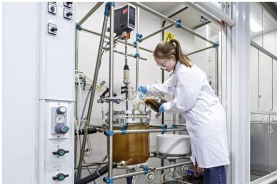
Neue Verwendungsmöglichkeit für Lignin aus der Papierherstellung: Wissenschaftler des Fraunhofer LBF haben Phosphor chemisch an das Lignin angebunden und können es nun als Flammenschutz für Kunststoffe nutzen. Foto: Raapke/Fraunhofer LBF
