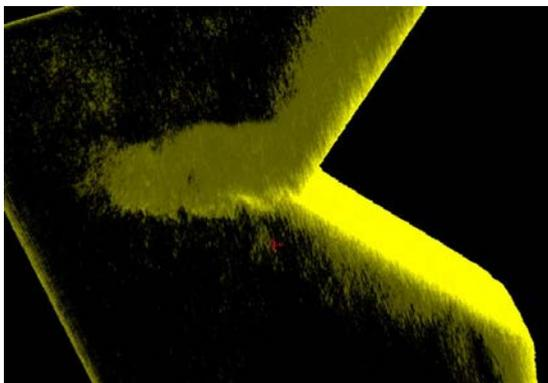
Dreidimensionale (3D) Darstellung eines Risses in der Kerbe einer faserverstärkten Kunststoffprobe.
