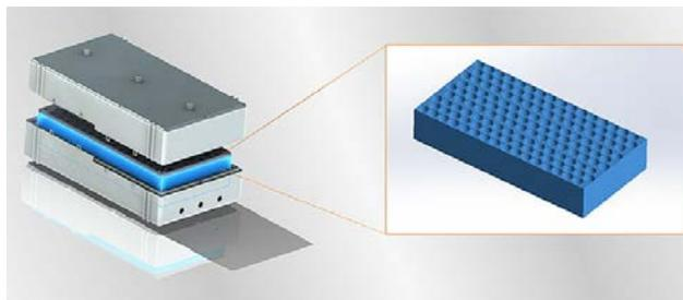
Ein neuartiger Phasenwechselmaterialverbund wird durch ein isolierendes Sandwich-Gehäuse thermisch von der Umgebung entkoppelt.
