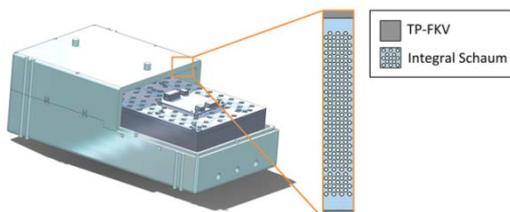
Ein am Fraunhofer LBF entwickelter Prozess ermöglicht die großserientaugliche Herstellung komplexer funktionsintegrierter FKV-Sandwich-Bauteile.
