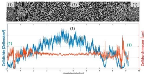
Analyse der Schaummorphologie anhand computertomographischer Aufnahmen: charakteristische Schaumeigenschaftenprofile wie Zelldichte und Zelldurchmesser können über die Bauteilgeometrie hinweg quantifiziert werden.
