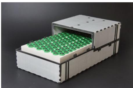
Prototyp des neuartigen Li-Ion Batteriemoduls mit hoher thermischer Speicherfähigkeit für Vorkonditionierungsmaßnahmen der Batteriezellen sowie einem großserientauglich hergestellten Faserverbund-Sandwich-Gehäuse mit hoher thermischer Isolationsleistung.
