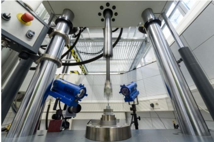
Dynamische Prüfung einer Kunststoffprobe mit dem Schnellzerreißer
