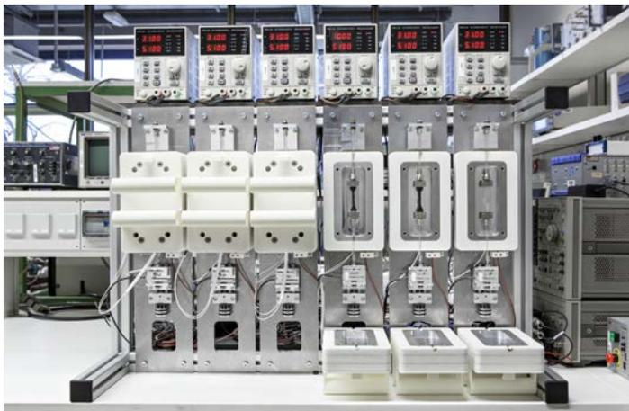
Neuentwicklung: Messaufbau zur gleichzeitigen Messung der Spannungsrelaxation bei sechs verschiedenen Temperaturen. Foto: Fraunhofer LBF/Raapke.
