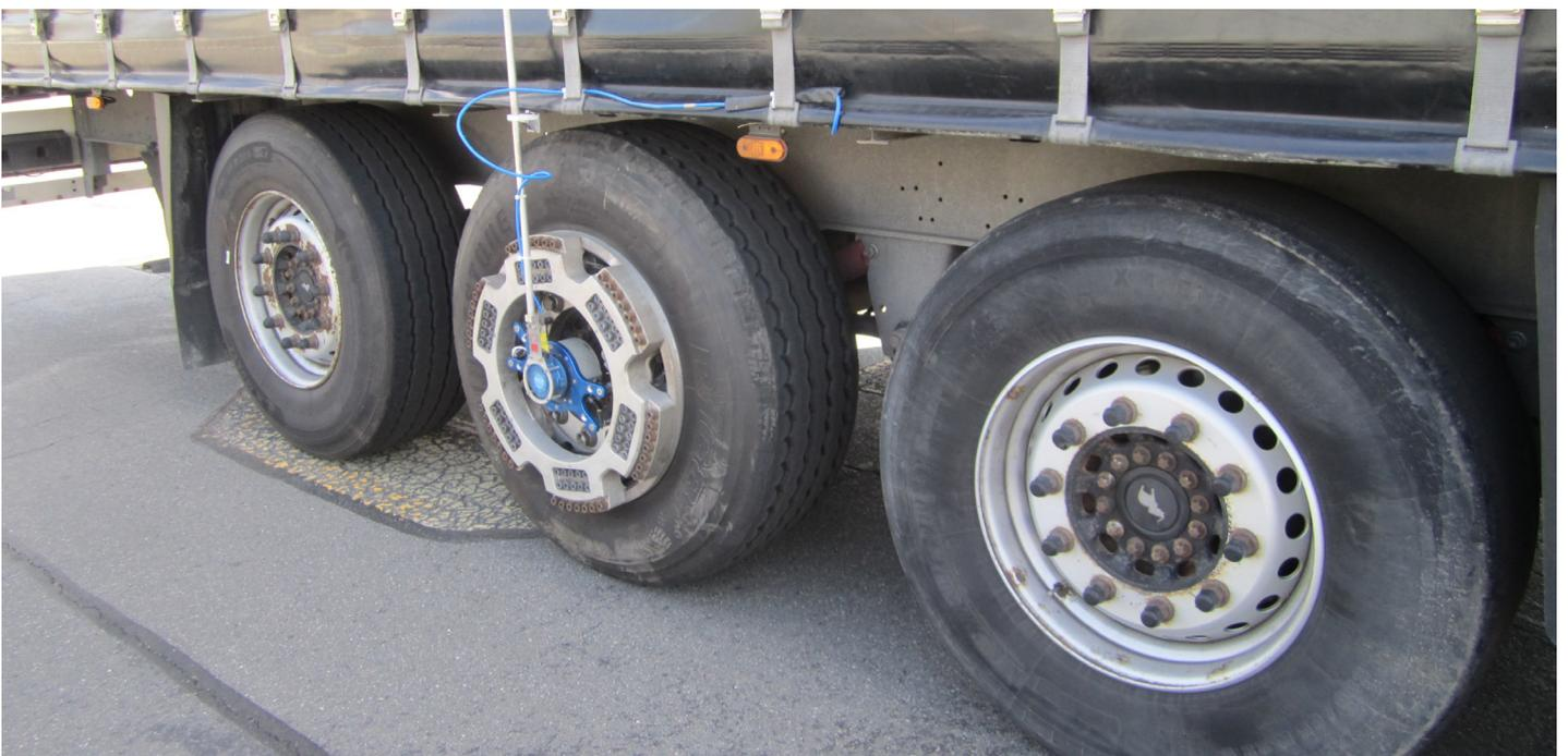
Radkraftsensor für Lkw-Messungen. Entsprechende Varianten für Personenkraftwagen und Einsatz im Gelände sind verfügbar.
