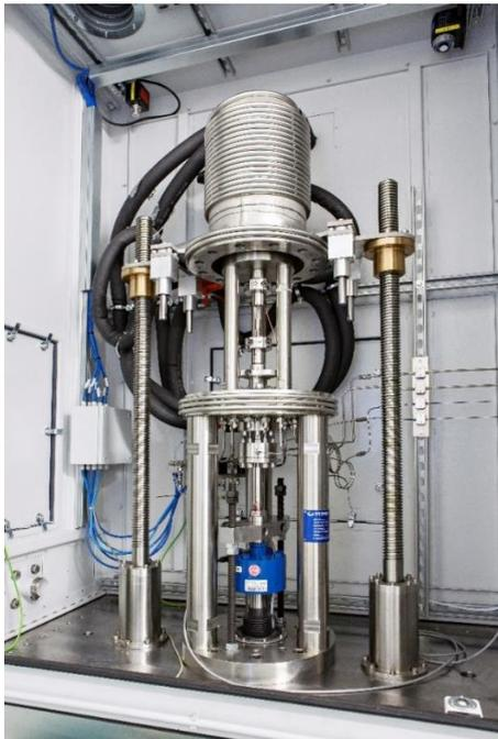
Versuchseinrichtung zur Durchführung von temperierten Ermüdungs- und Zugversuchen unter Druckwasserstoff, Stickstoffatmosphäre und Umgebungsluft.
